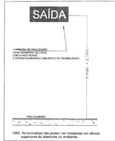
OBS. As luminárias não podem ser instaladas em alturas superiores às aberturas do ambiente. LUMINÁRIA DE SINALIZAÇÃO DE ABANDONO DE LOCAL TIPO FOTOLUMINESCENTE sem escala
