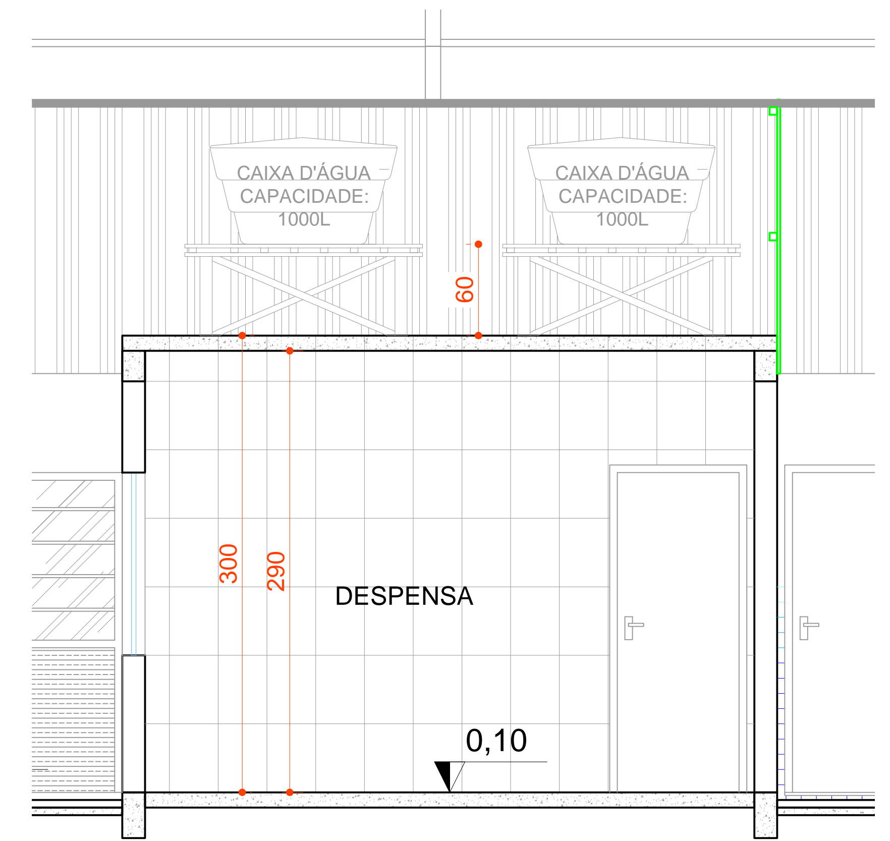
DETALHE DESPENSA ESCALA 1/25
